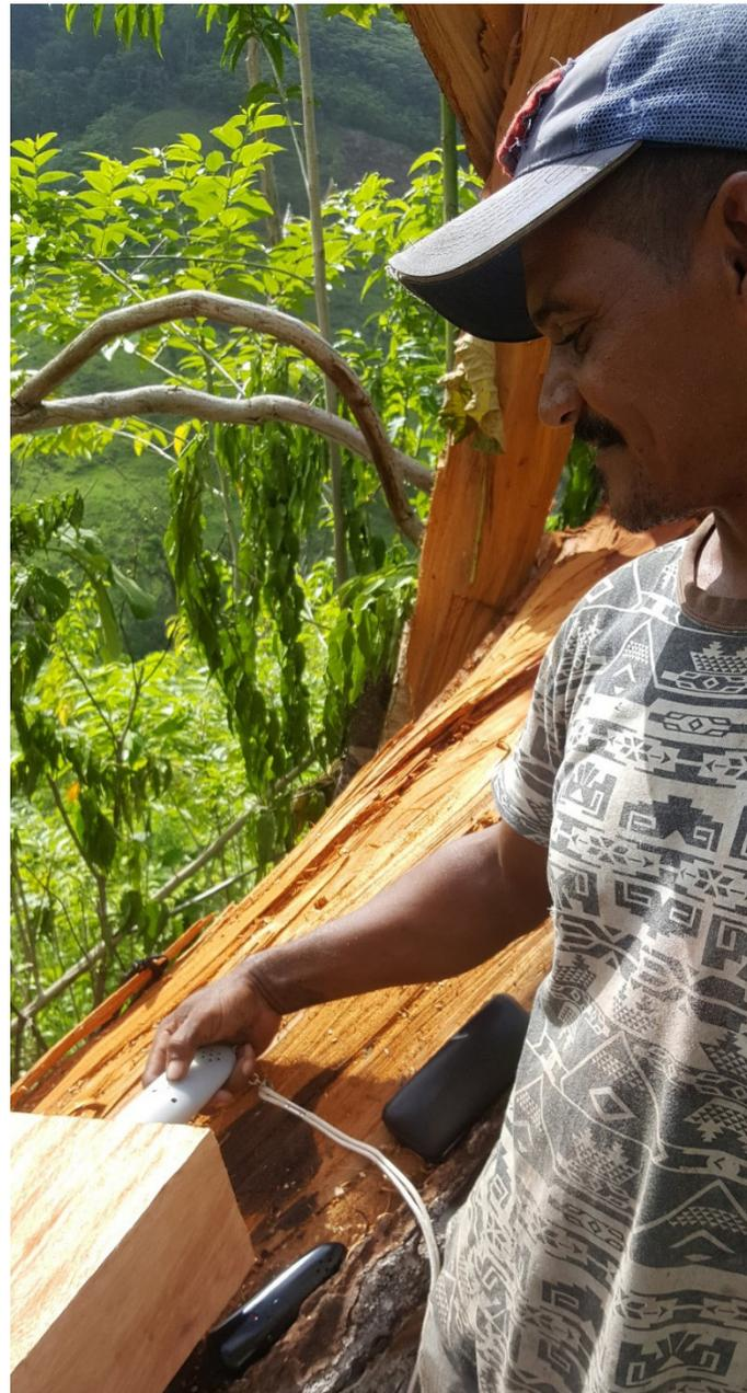
**Figura 15.** Aplicación del equipo “Stardust” para trazabilidad de la madera
